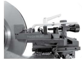
Le déflecteur de copeaux réduit la vibration et doit être utilisé à CHAQUE coupe.
