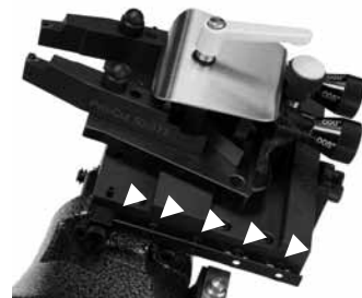
| Vue rapprochée des vis de serrage du lardon
