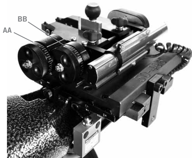
Vue rapprochée du bouton de réglage extérieur (AA) et du bouton de réglage intérieur (BB).
