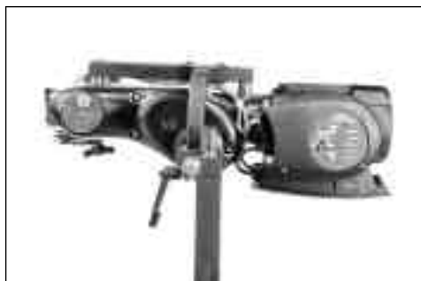
Tour pour frein vers le bas. Vous devrez installer le tour dans cette position pour réusiner l'autre côté du véhicule.
