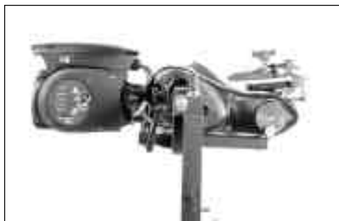
Tour pour frein vers le haut. Notez que le réglage de la tête de coupe est plus simple dans cette position.
